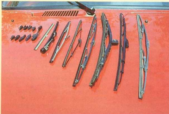
Отечественные щетки стеклоочистителя. Слева направо: для плоского стекла; “жигулевская” для очистки фар; “дворники” ЗА3-966; ВА3-2101... -2107; АЗЛК-2141; двойная щетка для ВА3-2108; штатная ВА3-2108; ЗА3-1102. Слева – переходники для импортных щеток.
